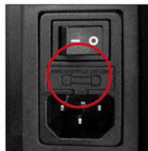
Photo 3: La cosse du fusible.
