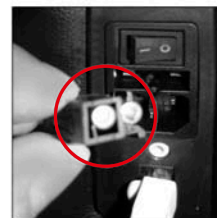
Photo 6: Fusible nouveau et fusible usagé.
